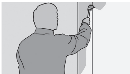
Рис. 91. Клей также наносится вокруг угла на соответствующую сторону стены.
