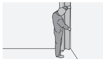
Рис. 86. Разверните покрытие так, чтобы рисунок был в вертикальном направлении. Поставьте рулон себе на ботинок. Это облегчит вам работу с рулоном.
